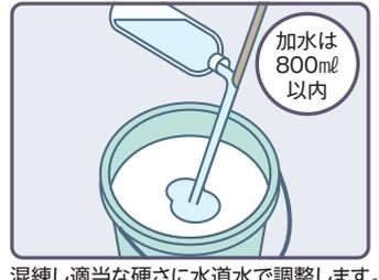
混練し適当な硬さに水道水で調整します。
