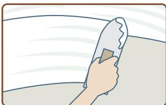
下地の状態を確認後、ソトカベースを下塗りします。骨材として5号珪砂を1セットにつき2kgまで添加可能です。
