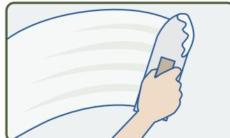
ウチカベースを薄く平滑に塗り付け、乾燥後に漆喰上塗りを行います。
